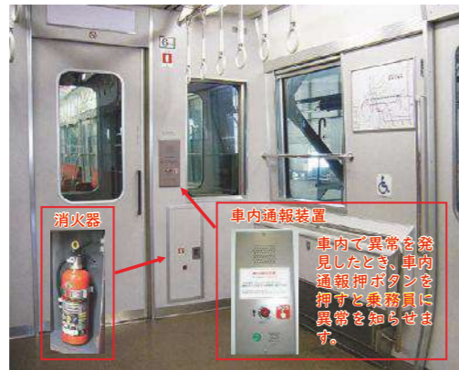
消火器と車内通報装置
