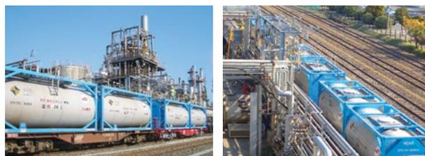
モーダルシフトの一例(鉄道タンクコンテナと荷役充填設備)
