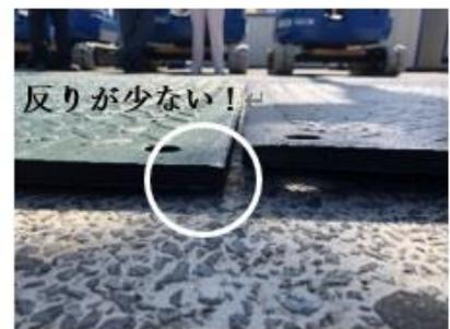
3×6サイズでは幅が足りなかった大型車両や重機も隙間なく並べて走行できます。**4×8サイズ最軽量、驚異の17.5kg**です。また、従来品（3×6サイズ）よりも素材を強化しており、軽さと強度の両立を実現。樹脂製品の弱点であった反りの発生も、素材の工夫（特許出願済み技術）により抑制しました。反りが発生しても、しばらくすると地面に馴染み、復元します。表面カラーは、従来品（3×6サイズ）のブラックに対し、グリーンにすることで表面温度・5℃の効果が得られました。反りの発生を抑制したり、真夏の炎天下での作業環境改善につながります。PS ライトは、現場の省力化を強力にサポートできる次世代の養生材です。
