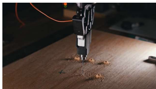
ロボットが自ら指定位置に移動し、穿孔作業を行う。
