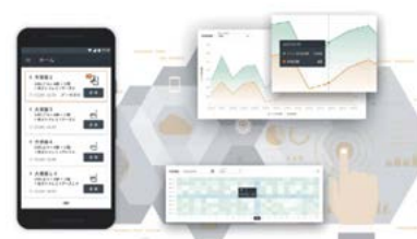
便器の使用状況をモニタリングできるIoTトイレ
