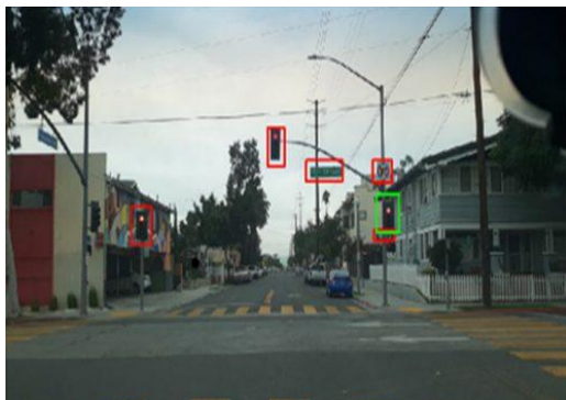
図1: CNNベースの交通標識検出分類器
