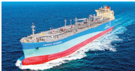
LPG燃料 新造LPG・アンモニア運搬船 [ENERGIA GRANDEUR]
