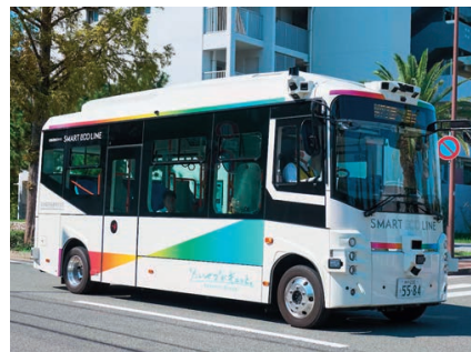
自動運転EVバス
