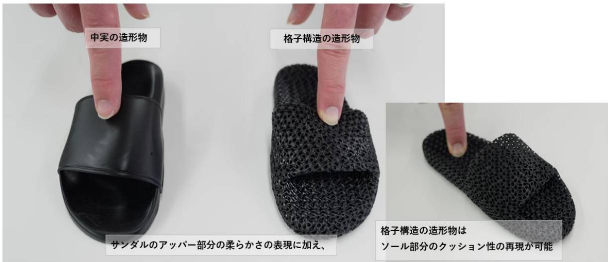
図 3. 生地のもろかさとクッション性を表現した造形物 市販の光造形式 3D プリンタで造形
