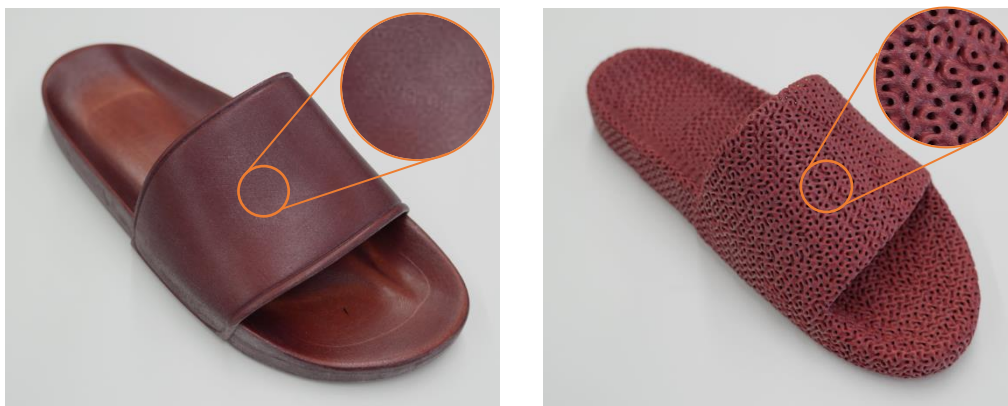
図 2. 中実の造形物（左）と格子構造の造形物（右）質量は約 15%軽い いずれも当社製フルカラー 3D プリンタで造形
