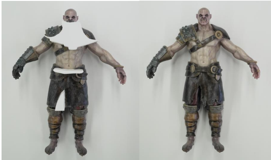
図 1. CG 生成データを調整せずに 3D プリントしたサンプル (左) データを調整して 3D プリントしたサンプル (右)
