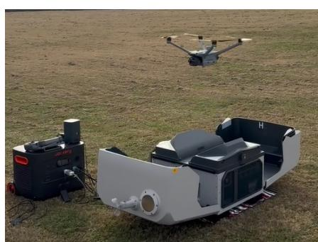
撮影には、DJI社が2025年に販売を開始した最新ドローンポート「Dock3」および産業用ドローン「MATRICE 4D/4TD」を使用。現場での手動操縦に加え、PC上の管理画面から遠隔で離発着や飛行を制御することも可能です\*。これにより、アクセスの難しい地域や広域エリアでも現地常駐を必須としない運用が可能となり、定期巡回やイベント撮影などの柔軟なドローン活用が実現します。さらに、遠隔運航を前提としたソフトウェア開発やシステム拡張が容易になり、ドローン活用の幅を一層広げることが期待されます。
