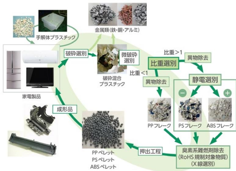
使用済みの家電製品を破碎して生じる破碎混合プラスチックは、比重選別、静電選別、X線選別などの選別過程を経て、プラスチックの種類ごとに高純度で回収され、再び家電製品に使用される。
