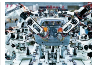
自動車ボディ組立ラインの スポット溶接ロボット[BXシリーズ]
