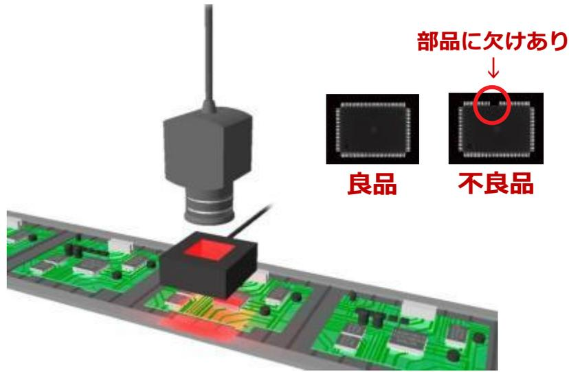
プリント基板の実装部品欠陥検査
