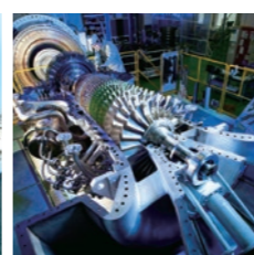
海外向けに初出荷した 30MW級ガスタービン
