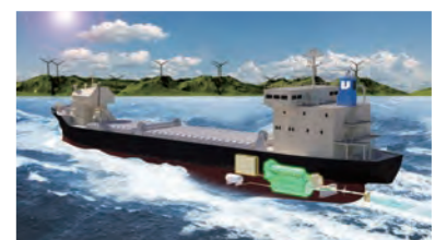
当社製ガスエンジンハイブリッド推進システムを搭載した「下北丸」
