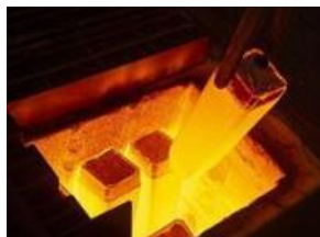
2020年4月に世界で初めて水素を燃料に用いた鋼片加熱に成功。
