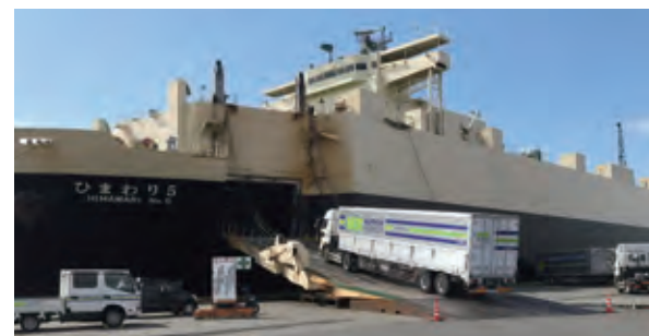
*RORO (Roll-on Roll-off) 船：トラックの貨物を積載したトレーラー部分のみを輸送する貨物船。
