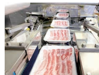
ガス置換包装商品の製造ライン
