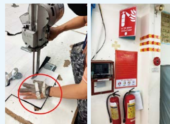
けが防止のため、金属の手袋を着用し生地を裁断する取引先従業員 消火器や救急用品の備え付け、緊急避難経路の確認
