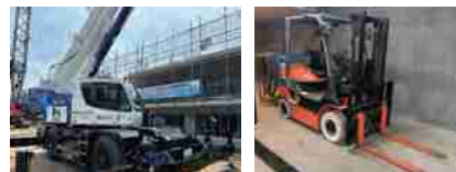
バッテリー式フル電動ラフトレナークレーンの採用 電動フォークリフトの採用
