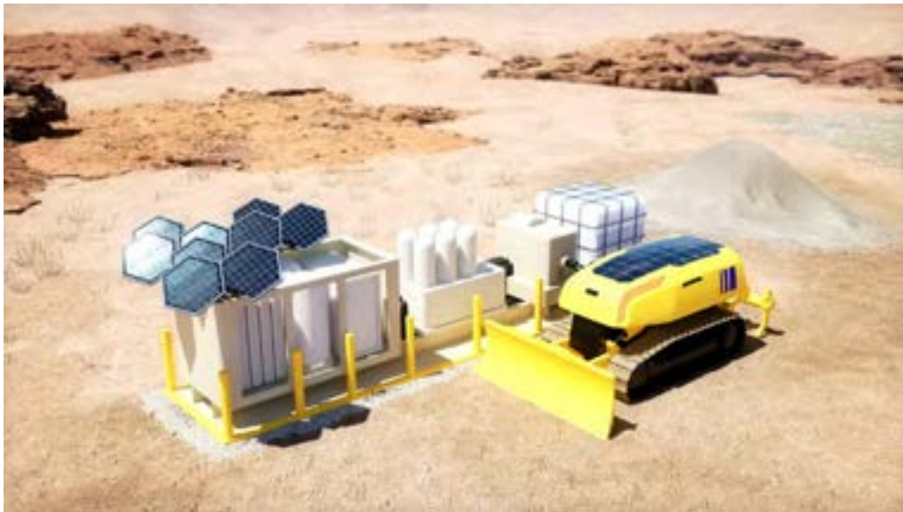
太陽光を水素として貯蔵し、電気に変換して建設機械に充電
