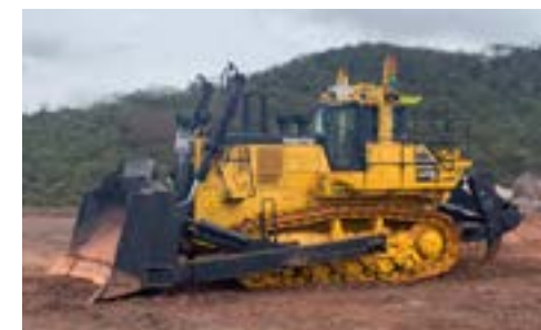
ブラジルの Minas-Rio 鉄鉱山で遠隔稼働するブルドーザー D375Ai-8
