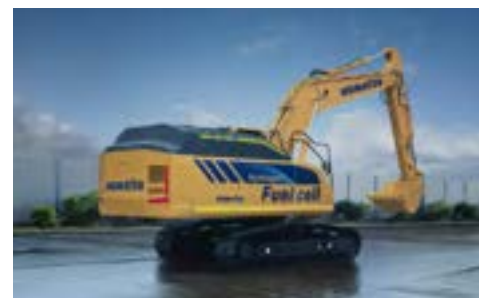
水素燃料電池を搭載した中型油圧ショベル (コンセプトマシン)
