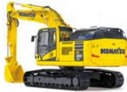
リチウムイオンバッテリー搭載 20 トンクラス 新型電動ショベル「PC200LCE-11」
