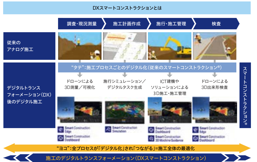
図：スマートコンストラクション®などのソリューションによるアプローチ
