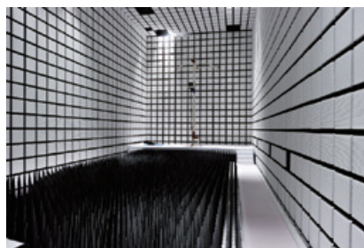
大型電波暗室
