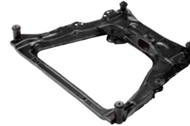
前輪側のサスペンションリンク類、ステアリングギアボックス、エンジン等の取り付け点をまとめて支持する骨格となる部品です。取り付け点を介して、タイヤからのさまざまな力に耐え得る強度、剛性および衝突時の衝撃吸収性が求められるため、適切な材料を配置して性能を満足させています。
