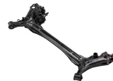
小型、中型乗用車の後輪側サスペンションの主流形式であり、中央部のクロスピームがねじれることで、左右のトレーリングアームが別々に動き、独立懸架式に近い特性が得られる部品です。さまざまな構造に対応することで、軽量化に貢献しています。
