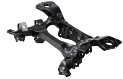
後輪側のサスペンションリンク類、デフ等の取り付け点をまとめて支持する骨格となる部品です。取り付け点を介して、タイヤからのさまざまな力に耐え得る強度、剛性が必要となりますが、高強度材の使用による軽量化も両立させています。
