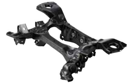
後輪側のサスペンションリンク類、デフ等の取り付け点をまとめて支持する骨格となる部品です。取り付け点を介して、タイヤからのさまざまな力に耐え得る強度、剛性が必要となります。高強度材の使用による軽量化も両立させています。
