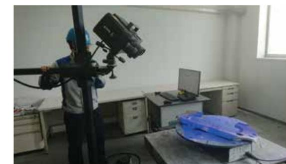
画像式非接触測定機による計測
