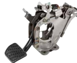
足の操作だけで自動車の速度を管理する重要保安部品です。運転者が直接触れるインターフェース部品であり、足からの入力に耐え得る強度・剛性が必要となります。レバーは厚板、パイプ、薄板溶接等、さまざまなタイプに対応し軽量化にも貢献しています。
