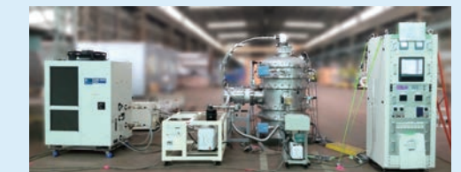
液化水素タンク底部真空排気実証実験装置
