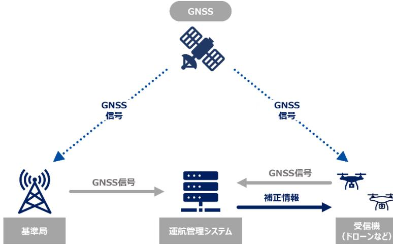
「RTK-GNSS アンテナ」は、高精度な位置情報を取得するためのアンテナです。RTK は「Real-Time Kinematic」の略で、GNSS は「Global Navigation Satellite System」を意味します。「RTK-GNSS」は、衛星からの信号をリアルタイムで処理し、数センチメートルの精度で位置情報を提供します。これにより、非常に高い精度で位置を特定することができます。主に測量、農業、自動運転、ドローン運航などで利用されています。
