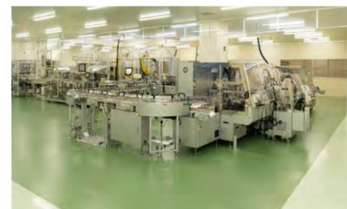
本包装ラインは、PTP（press through pack）加工から最終包装（元梱箱）までを行う一貫製造ラインです。36万錠/時が包装でき、パレットへの元梱箱の積み込みまで自動化されております。課題であった運搬・保管のムダを解消し、作業者の関与を最小限にするための工夫を取り入れ、省人化を実現することにより、これまでの製造設備よりもコストダウンが図れると見込んでおります。
