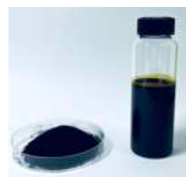
回収されたカーボンブラック(左)と分解油(右)
