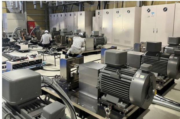
愛知県内にある SkyDrive の試験施設に設置されている東陽テクニカ製「電動推進システム評価ベンチ」©SkyDrive
