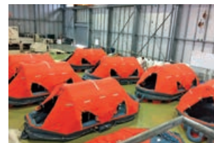
救命筏整備作業
