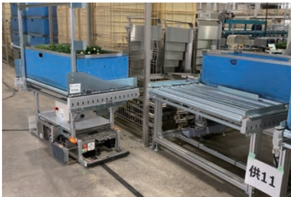
AGVで作業員へ供給
