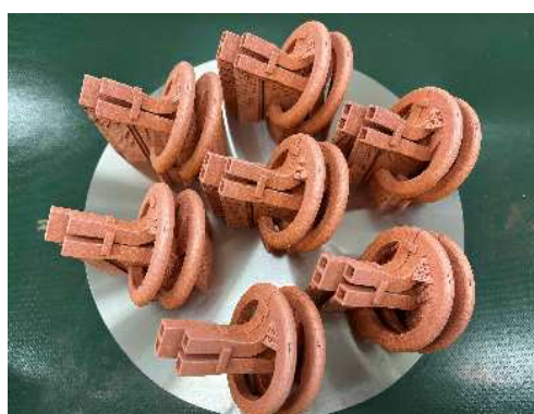
金属3Dプリンターによる純銅製誘導加熱コイルの一例
