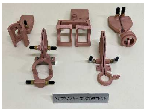
金属3Dプリンターによる純銅製誘導加熱コイルの一例
