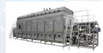
炊飯装置(無菌包装米飯製造装置 製造ラインの一部)
