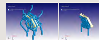
金属3Dプリンタを用いて製造した金型。内部には冷却配管が最適に設置されている
