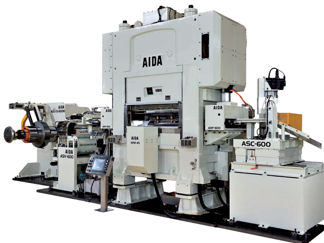
「2023年十大新製品賞（本賞）」を受賞した EV駆動用モーターコア生産向け 高速精密プレスライン（プレス機械はモデル機）
