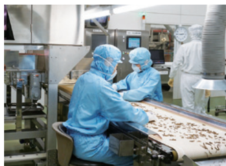
AIを搭載した生薬自動選別機および2名での生薬選別作業
