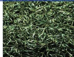
人工芝のパイルを特殊捲縮加工(ミズノスパイラルテクノロジー)した「MS CRAFT」シリーズでは、パイルのちぎれを少なくして充填材のゴムチップ等の飛散・流出を抑制し、マイクロプラスチック流出の抑制しています。
