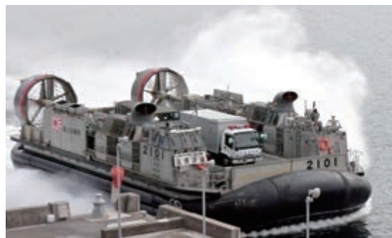
海上自衛隊との連携訓練の様子 (エアクッション艇への高圧発電機車の搭載・搬送訓練)
