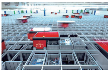
ロボットストレージシステム
