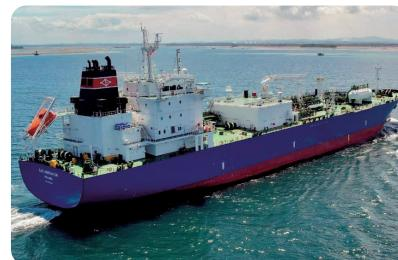
アンモニア二元燃料主機関レディ仕様のアンモニア運搬船
