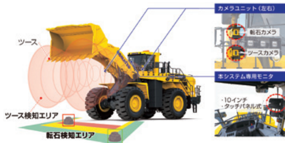
【ツース脱落と転石の自動検知支援システムのイメージ】
