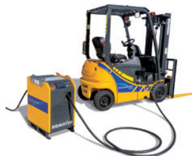
【ナトリウムイオンバッテリーを搭載した電動式フォークリフトのコンセプトマシン】
