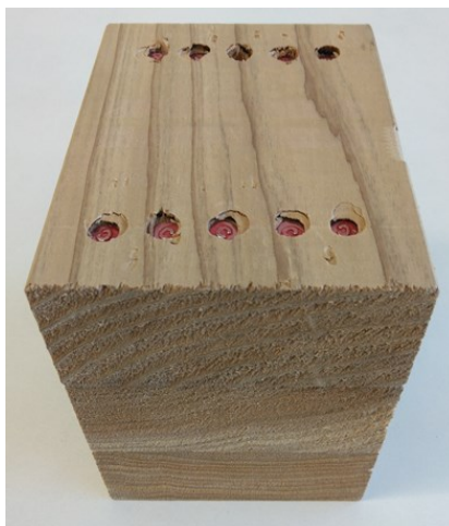
杉材に「木割れ最強釘Ⅱ杉対応」を打込んだ写真。間隔を狭くしても、木割れが発生していません。
