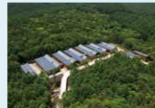
2013 生長の家 森の中のオフィス 省エネと創エネにより日本初の ZEBを実現
