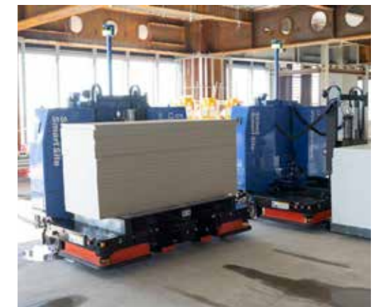
搬送効率を向上させる「Robo-Carrier」
