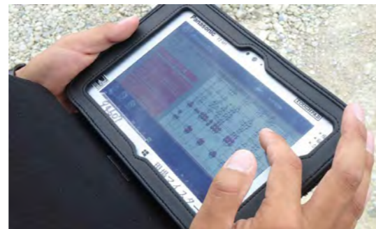
施工管理の ICT 化（「現場検査マイスター（COLMINA 施工検査シリーズ） ® 」のタブレット）
