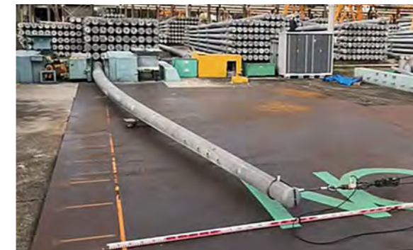
ポールの曲げ性能を確認する試験を定期的実施
