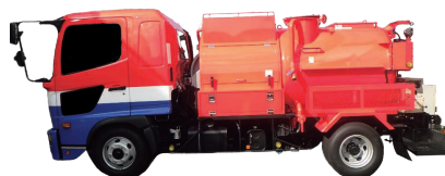
高圧洗浄車(JS-04S2320A)
