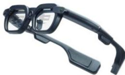
メガネ型のデザインを採用し、軽量・コンパクト化を実現した「JAPAN MADE」の XR グラス。スマホと無線接続することで操作し、レンズが透過型ディスプレイとして動作します。前面に搭載されたカメラにより、Vlog も作成可能。6DoF 対応のセンサーが搭載されており、幅広いシーンでの活用、多様なサービスの提供が期待されています。また、本デバ
