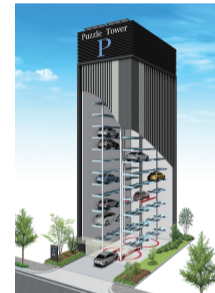
タワー式パーキングシステム (パズルタワー)
