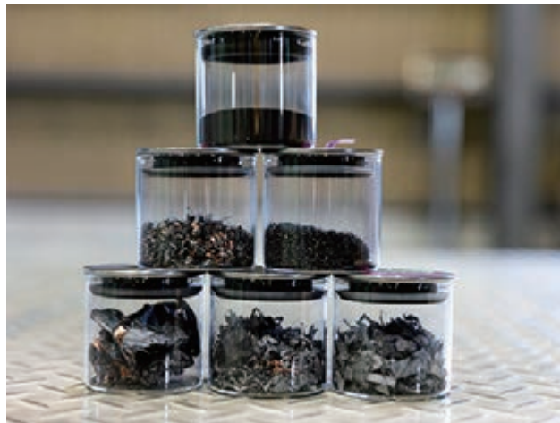
処理された破片とレアメタルを多く含んだ粉末 (写真：トヨタタイムズ)
