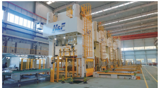
【中国向け自動車部品製造用プレス機械（タンデムプレスライン）】
